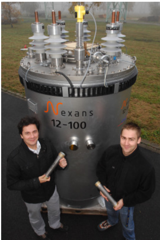
Bild: Nexans SuperConductors, Hürth, lieferte den weltweit ersten kommerziellen supraleitenden Strombegrenzer aus.
