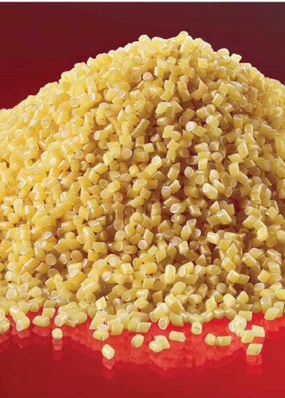
PUR-Medoxprotect-S von Nexans ist ein neues Mantelmaterial, das schwerer zu entflammen und selbstverlöschend ist.
