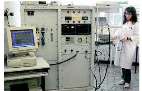
Im Cone-Calorimeter von Nexans Nürnberg hat die neue Kabelmantelmischung PUR-Medoxprotect-S ihre Feuerprobe bestanden.
