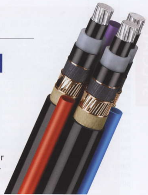
Die Zwickelräume des MS-Hybridkabels sind mit Leerrohrsystemen bestückt, die nachträglich mit Lichtwellenleitern versehen werden können.
