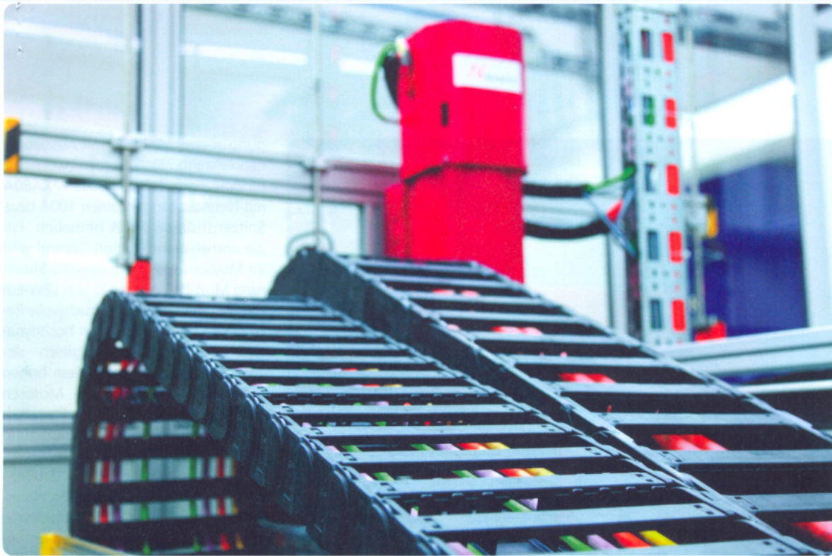
Bild 1: Nexans betreibt in seinem Research Center mehrere Schleppketten-Testanlagen mit unterschiedlichen Verfahrenswegen. Hier werden Kabel und Schleppketten bis zu 50m/s 2 beschleunigt.
