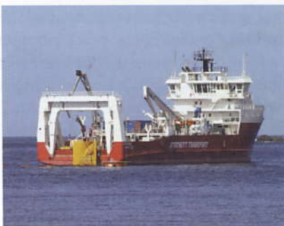
Abb. 2 Das Verleges Schiff Elektron im Einsatz
