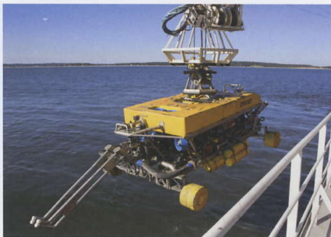
◀ Abb. 4 Der CAPJET ist speziell für die Seekabelverlegung ausgelegt.
