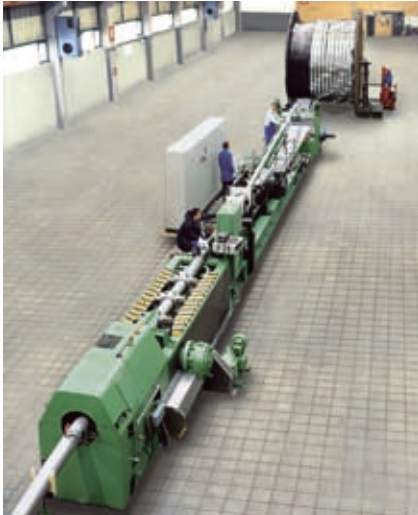
Fertigung von vakuumisolierten CRYOFLEX®-Leitungen für HTS-Kabel
